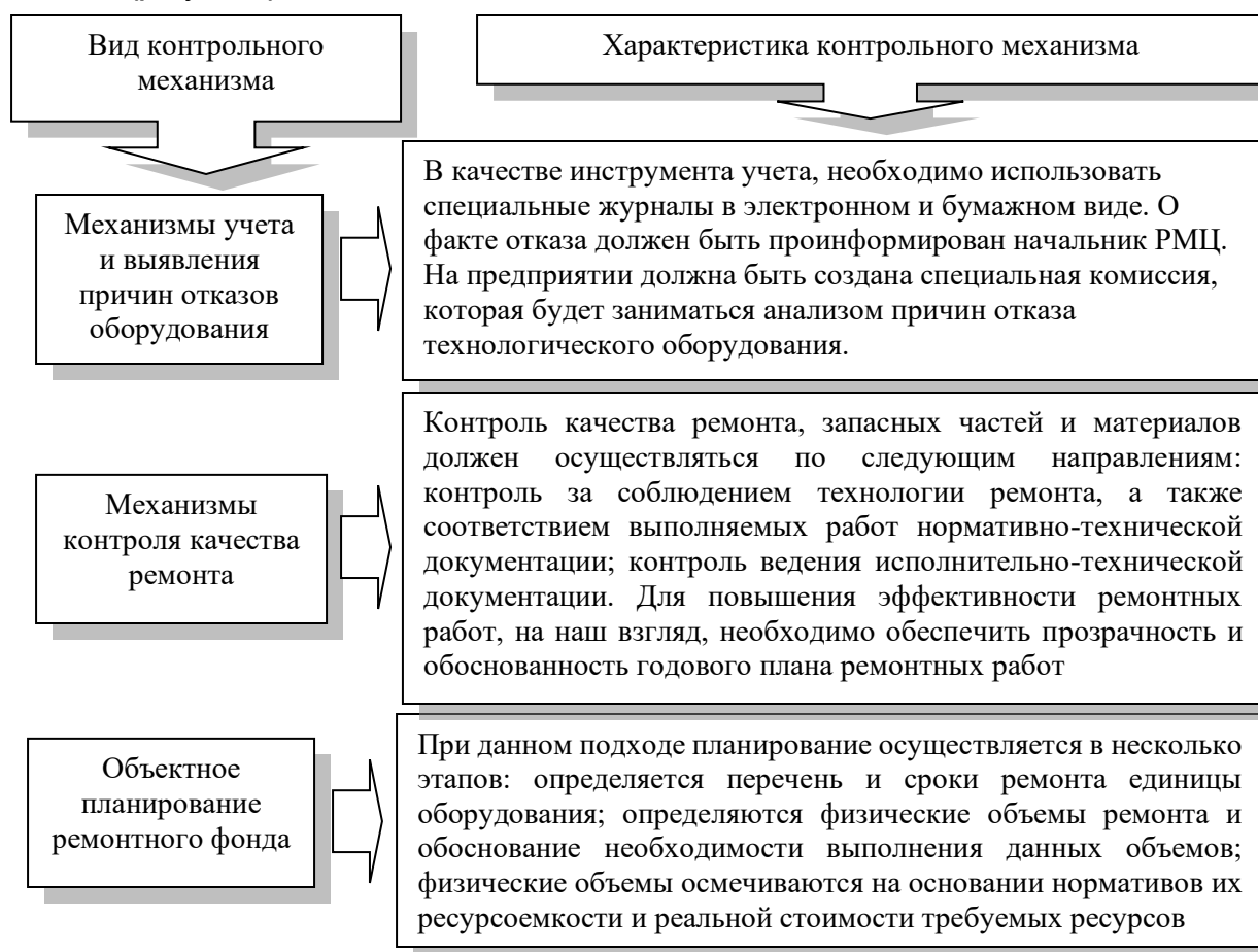
Рисунок 5. Контрольные механизмы повышения надежности технологического оборудования и снижения количества отказов его работы
